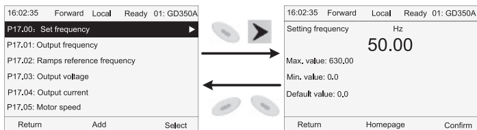
Рис 5.17 Интерфейс состояния «Мониторинг»
